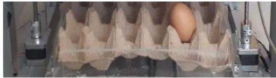
Gambar 11. Posisi Motor Stepper Axis Z dan Z1
