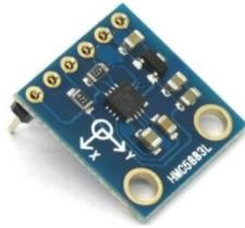
Gambar 2.4 Sensor Magnetik Kompas HMC5883L
