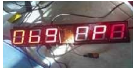
Gambar 3.2 Rangkaian yang telah di aliri tegangan
